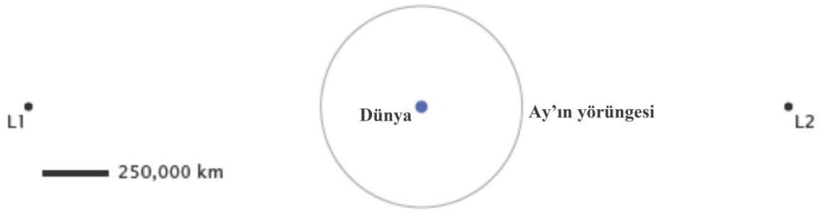
Şekil 7: L1 Lagrange noktası. Lagrange noktası dünyadan 1.5 milyon kilometre uzakta olup bu uzaklık yaklaşık olarak ayın dünyaya olan uzaklığının beş katıdır (NASA, 2009).
