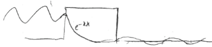
Şekil V: Yüksek veya geniş engel limitinde geçiş üssel olarak azalır zira engel içindeki dalga fonk.'da üssel bozunan terim hakimdir.
